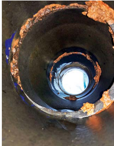
Abb. 1: Gelblich-weiße, verklebte Mehlreste an den Muffen eines T-Stücks in einem Trinkwasserrohr
