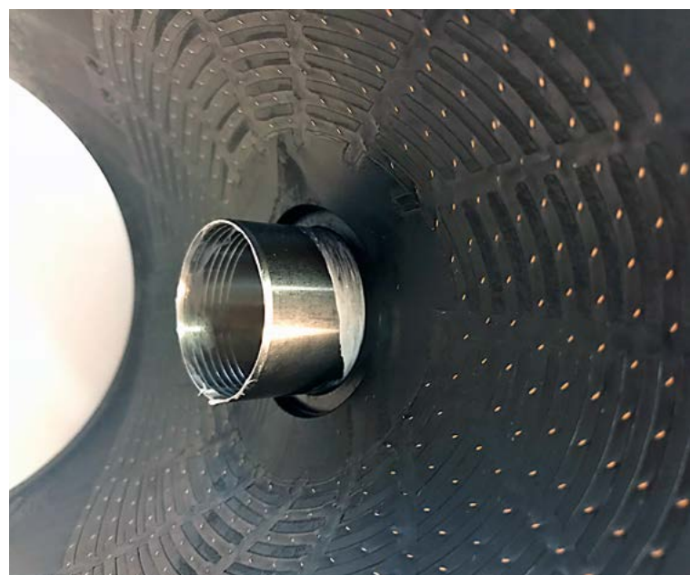
Abb. 3: Fett am Fräskopf eines neuen Druckanbohrventils
