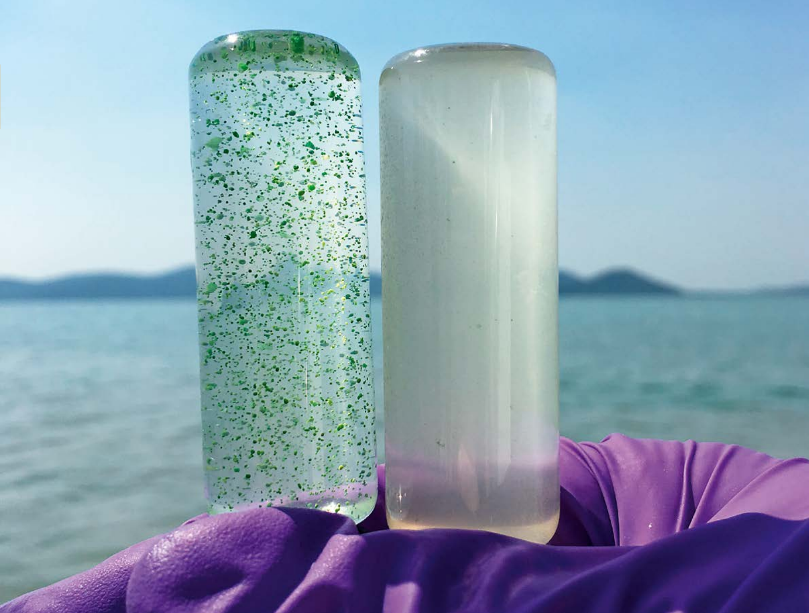
Wasserproben aus unterschiedlichen Tiefen des Tai-Sees. Linke Probe von der Oberfläche mit hohem Algenanteil, rechte Probe vom Seeboden (2 m im Durchschnitt) mit hoher Trübung
